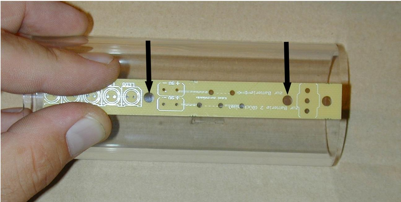
Dasselbe macht man genau gegenüber der ersten beiden Markierungen. Diese 4 Markierungen werden mit einem 4 mm Bohrer auf einer Ständerbohrmaschine (oder einer herkömmlichen Handbohrmaschine mit Halterung) aufgedrht. Um die Platine nun mit dem Batterien in das Gehäuse schieben zu können, muss eine Aussparung beim Schalter ausgefeilt werden (gestrichelter Bereich).
